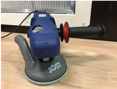
Gelochte diamantbesetzte Schleifscheiben für das P1-Schleifsystem der Fa Jöst:
